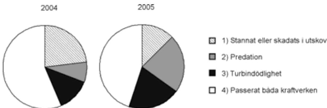
Figur 6. Resultatet av smoltstudierna i Emån 2004 (N=39) och 2005 (N=40). De smolt som släpptes ut stannade (1), blev uppätta (2), dog i kraftverkens turbiner (3) eller överlevde passagen av båda kraftverken och fortsatta nedströms(4).
